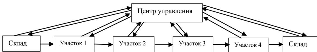
**Рис. 2. Выталкивающая система управления**
